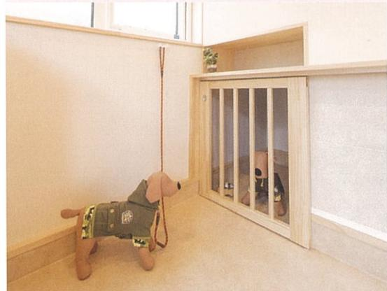
K 駅のリビングの一角、床を約 15cm 下げてドッグスペースに。床を下げることで抜け毛などがリビングに入ることを防止。床は防水仕上げになっているので、粗相をしても水で洗い流すことができます。また、天井埋め込み形ナノイー発生機（カビ菌やウイルス、ニオイ、アレル物質などを抑制）を設置しているので、ニオイも気になりません。また、階段下を利用してドッグケージも設置。壁は手入れのしやすいキッチンパネルと調湿消臭機能のある建材、天井も調湿消臭機能のある建材、さらに壁内はセルローズファイバーを充填して吸音性ももたせています。
