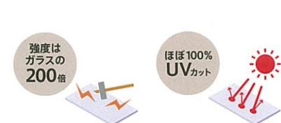
標準装備している屋根材は、有害な紫外線をカットし、ガラスの約200倍の強度を持つポリカーボネート。
